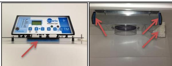
14.2 Ôtez la batterie et amenez-la dans un centre de recyclage. Ne la jetez pas au feu ou avec les déchets ménagers. Le support de la batterie est situé à l'arrière de l'armoire des contrôles.
