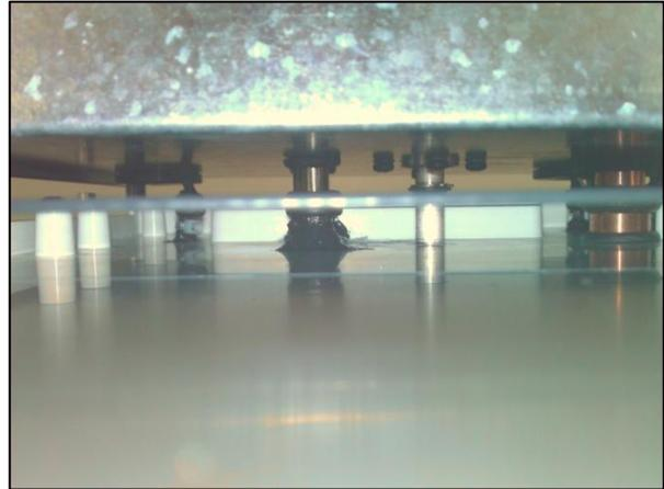
14.5 Überprüfen, ob die Antriebswellendichtung vorliegt und leicht an der Leiterplatte anliegt. Falls die Dichtungen ausgetauscht werden müssen, Brinsea Products kontaktieren. Eine fehlende Dichtung kann zum Entweichen des Sauerstoffgases und damit zu einer Brandgefahr führen.
